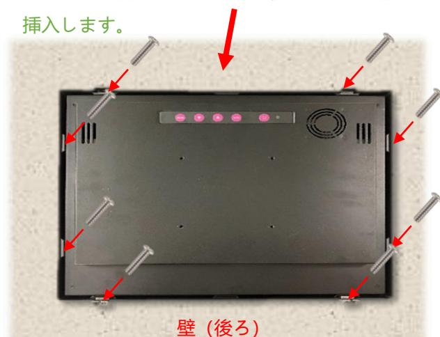
ステップ3: 裏側からクリップを取り付け、ネジで固定します。(最大9個のクリップを取り付けることができます。)
